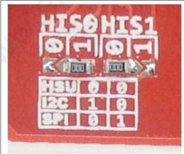
Figura 17 - Configuração UART do módulo NFC
